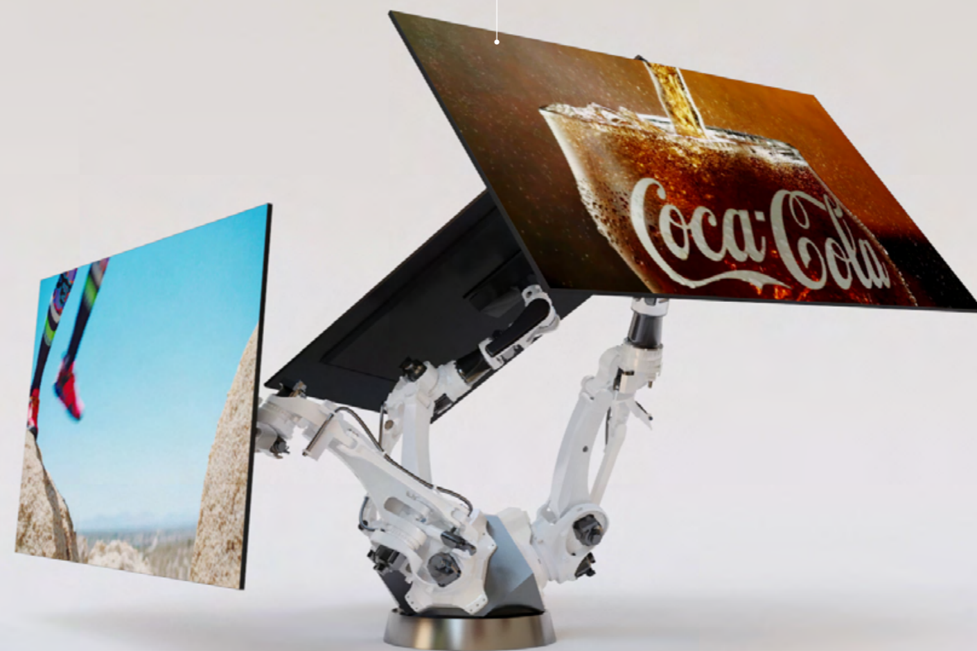
Digital Signage Prototyp innowacyjnego mocowania ekranów LED na ramionach robota Kawasaki
